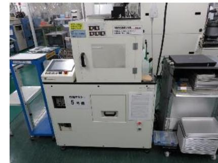
今回、ガス流量、真空度、高周波出力をモニタするセンサを取り付け、遠隔地からモニタリングできるシステムを構築
