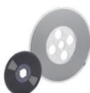
樹脂のなかに導電粒子を持ち、導通と絶縁の特性を兼ね備えたフィルム型の接合材料。ディスプレイパネルやカメラモジュールなどを構成する電子部品の接続に使われています。また、狭小スペースでの実装が可能な粒子整列型 ACF や、基板の形状や端子配置に合わせた形状加工 ACF もラインナップしています。
