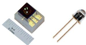
**光半導体**は、電気を光に、または光を電気に変換することができる物質です。この物質を使った身近な製品には、LED照明やリモコンがあります。その他、私たちがインターネットで動画を見たり、ゲームをしたりする際には、データセンターとの間で大量のデータが高速にやりとりされますが、そのデータ通信を支えているのも**光半導体**です。さらに、医療機器では体内情報の測定に、工場では製造ラインのセンサーに、その他にも数多くの機器のなかで使われています。
